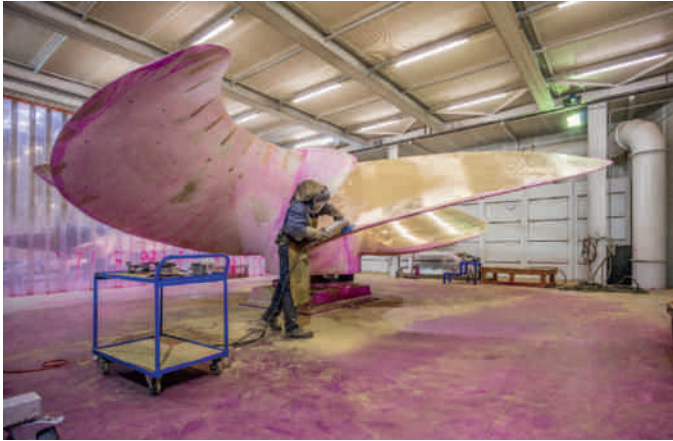
Maßnahme. Zu den Stellschrauben, an denen E.R. Schifffahrt bei seinen Schiffen gedreht hat, gehören neue Propeller mit optimierten Strömungseigenschaften. Sie stammen von der Mecklenburger Metallguss GmbH (MMG).
