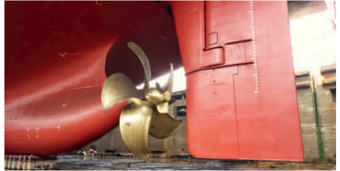
Maßnahme. Zu den Stellschrauben, an denen E.R. Schifffahrt bei seinen Schiffen gedreht hat, gehören neue Propeller mit optimierten Strömungseigenschaften. Sie stammen von der Mecklenburger Metallguss GmbH (MMG).
